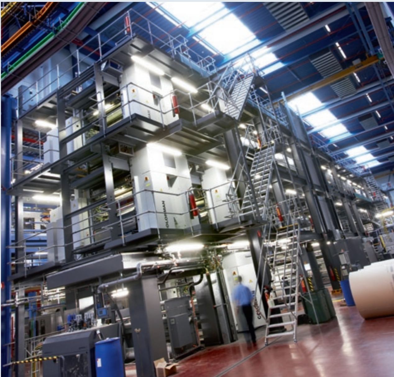
's Werelds grootste dubbelbreed heatsetkrantenpers werd geïnstalleerd bij Roularta, België. Elk van de vier Colorman-druktorens is uitgerust met een horizontale MEGTEC-droogoven. De drukpers heeft twee vouwmachines voor de afzonderlijke productie van tabloid- of broadsheetkranten. Bron MAN Roland.
